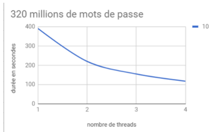
Figure 4 : Evolution du temps sur un rockyou concaténé 10 fois
