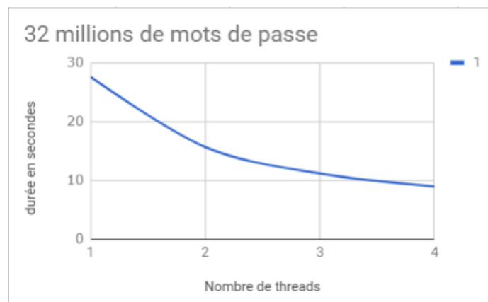
Figure 3 : Evolution du temps en fonction du nombre de threads sur rockyou
